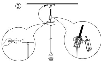
1. Koppla in sladdarna från lampan med en lampkontakt, eller direkt mot ledningarna från taket beroende på om det finns takkontakt eller inte. Blå mot blå och brun mot brun.
