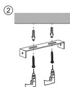
1. Montera fästet i taket med hjälp av plugg och skruv.
